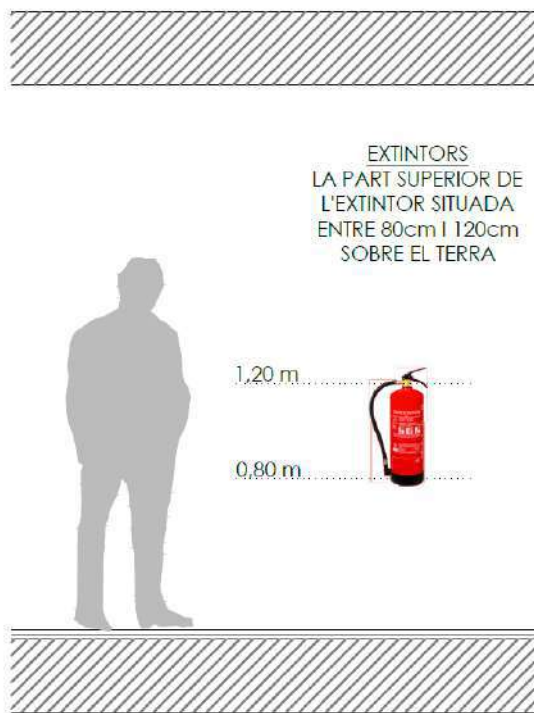
Alçada d'instal·lació dels extintors
